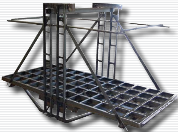
robuster Kabinenträger für einen Lastenaufzug
